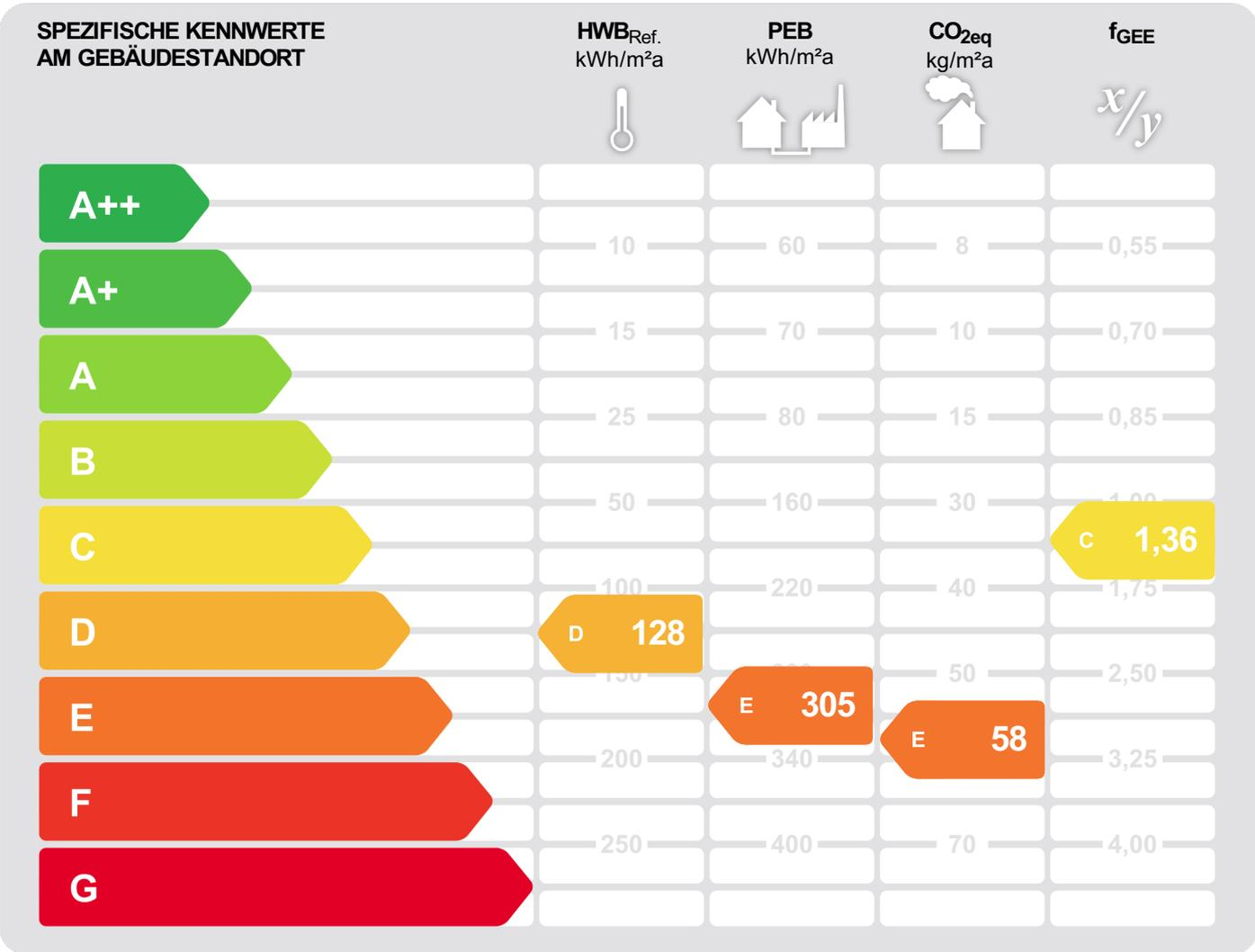
**HWB<sub>Ref.</sub>:** Der **Referenz-Heizwärmebedarf** ist jene Wärmemenge, die in den Räumen bereitgestellt werden muss, um diese auf einer normativ geforderten Raumtemperatur zu halten. Dabei werden etwaige Erträge aus Wärmerückgewinnung raumluftechnischer Anlage nicht berücksichtigt.
