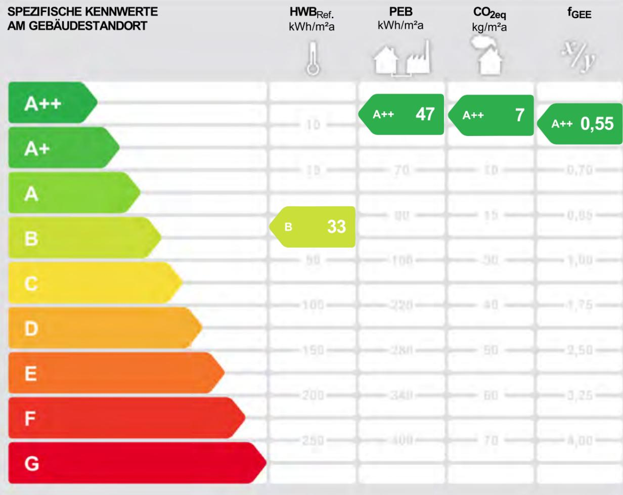
**HWB<sub>Ref.</sub>:** Der Referenz-Heizwärmebedarf ist jene Wärmemenge, die in den Räumen bereitgestellt werden muss, um diese auf einer normativ geforderten Raumtemperatur zu halten. Dabei werden etwaige Erträge aus Wärmerückgewinnung raumluftechnischer Anlage nicht berücksichtigt.
