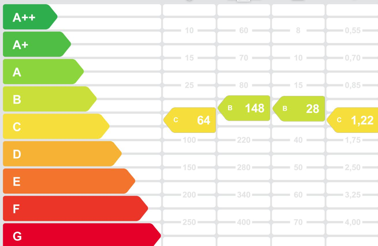
**HWB<sub>Ref.</sub>:** Der **Referenz-Heizwärmebedarf** beschreibt jene Wärmemenge, die in einem Raum bereitgestellt werden muss, um diesen auf einer normativ geforderten Raumtemperatur (bei Wohngebäude 20°C) halten zu können. Dabei werden etwaige Erträge aus Wärmerückgewinnung bei vorhandener raumlufttechnischer Anlage nicht berücksichtigt.
