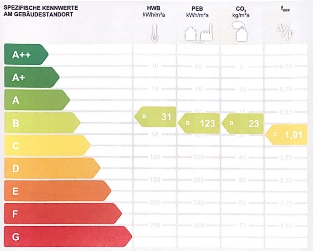
**HWB:** Der **Heizwärmebedarf** beschreibt jene Wärmemenge, die in einem Raum bereitgestellt werden muss, um diesen auf einer normativ geforderten Raumtemperatur (bei Wohngebäude 20°C) halten zu können.
